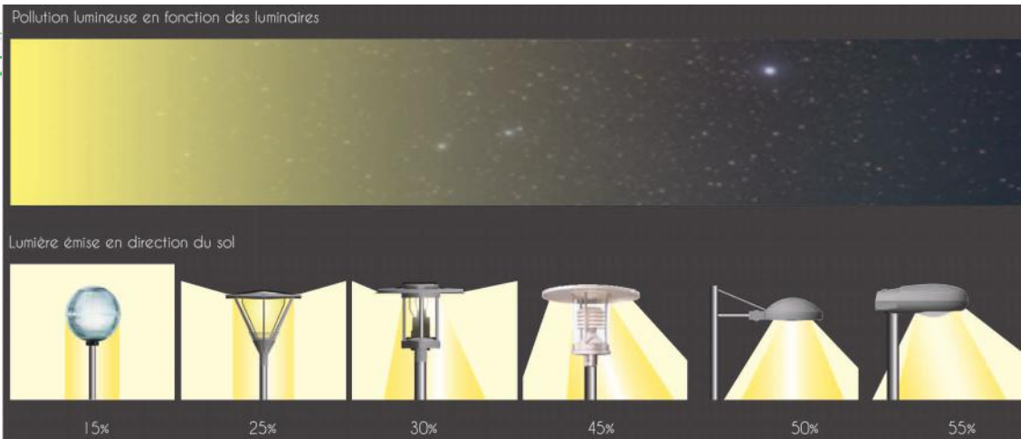
Efficacité de flux et pollution lumineuse en fonction du type de luminaire. Source : Acere.
