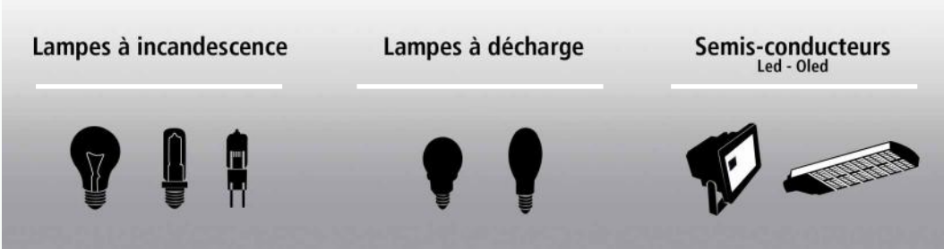
Les trois grands types de sources de lumière artificielle.
